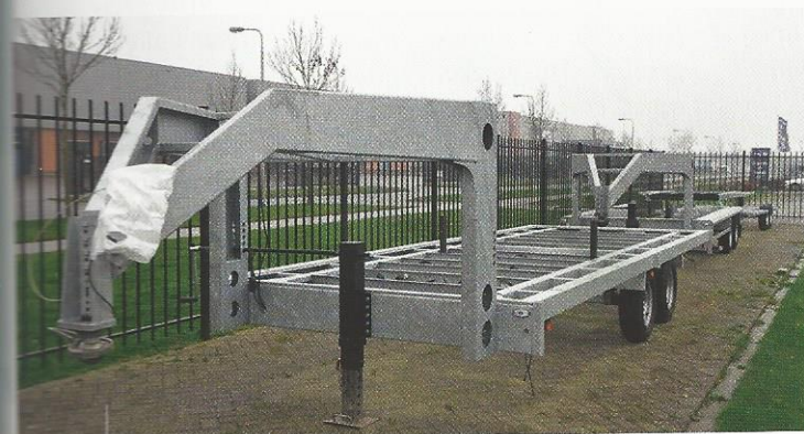
AANHANGWAGENCHASSIS GEREED VOOR OPBOUW EN BEDOELD OM DOOR EEN PICK-UP VOORTGETROKKEN TE WORDEN.
