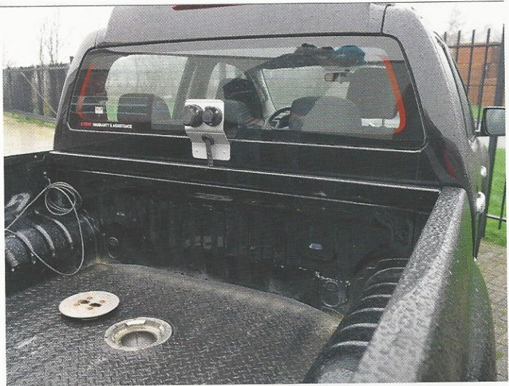
ZO ZIET DE 'KOM-KOPPELING' ERUIT IN DE LAADBAK VAN EEN PICK-UP.
